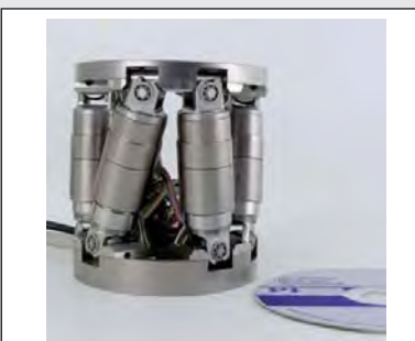
M-810, Miniature Hexapod Ø=100mm, H=118mm, max Load= 5kg, X,Y: +/-20mm, Z: +/-6.5mm, rot U,V +/-11°, rot W +/- 30°
